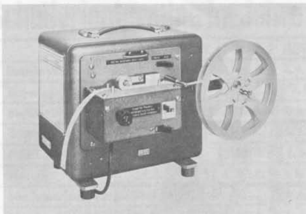
Morse-Übungsgeber Typ MG 23 - zur Aussendung von Morsezeichen mittels Wheatstone-Code-Lochstreifen sowie für Handtastung mit automatischer Pausenverlängerung
