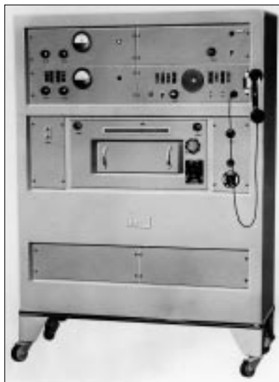
Das erste von Herrn Mebes gefertigte Telebild-Empfangsgerät. Entwickelt wurde es für die Deutsche Bundespost. Es wurden lediglich fünf Geräte gefertigt. In Deutschland konnten Telebilder ausschließlich von der Bundespost gesendet und empfangen werden.
