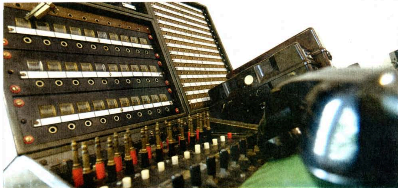
Steckverbindung: An Vermittlungsstellen wie diesem Hell-Produkt sorgten in den 1950er bis 1960er-Jahren zumeist die Fräuleins vom Amt für Telefonkontakt
