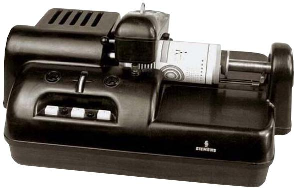
Das Kleinfax KF 108 brauchte etwa vier Minuten, um eine Seite zu übertragen und brachte den Durchbruch der Faxtechnologie.
