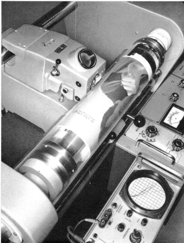
Der elektronische Farbrechner ist an der Bedienungsseite des Chromagraph an das Gerät angebaut. Seine Elektronik besteht aus auswechselbaren, transistorierten Schaltplatten, von denen jede eine bestimmte Rechenfunktion ausführt. Links neben den Farbrechner wird der auf besonderen Wunsch lieferbare Oszillograph montiert. Mit ihm können Gradation, Farbkorrektur, Farbrücknahme und andere Funktionen sichtbar gemacht und überwacht werden.
