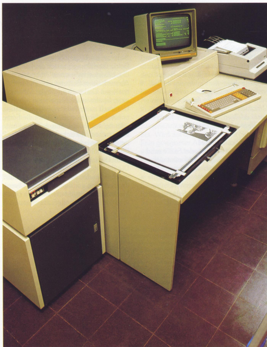
Der Digigraph 40 A 40 tastet Strich- und Halbtonbilder ab, digitalisiert sie und speichert die Daten auf Magnetplatten.
