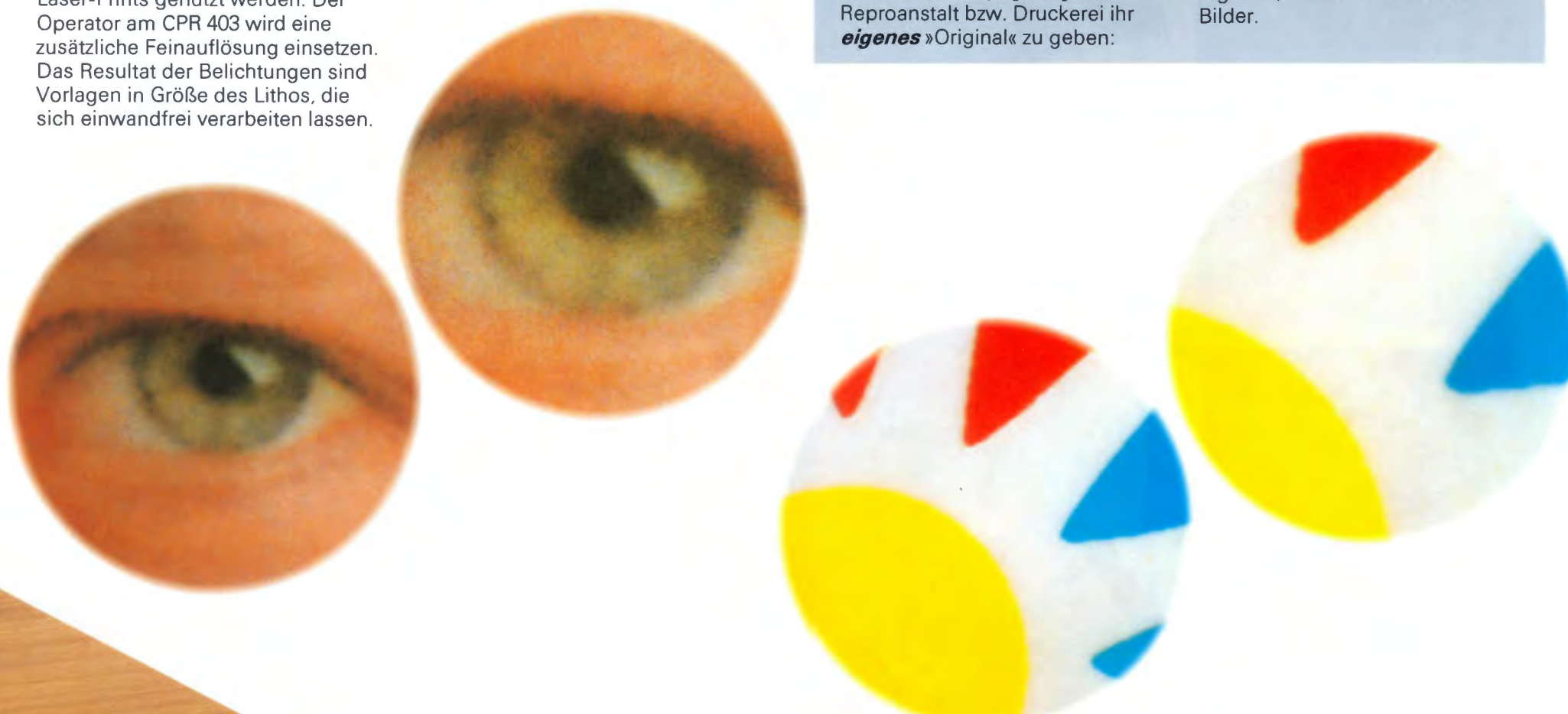
Makroaufnahmen aus einem Laser-Print in 10-, 15-, 30- und 45-facher Vergrößerung.
