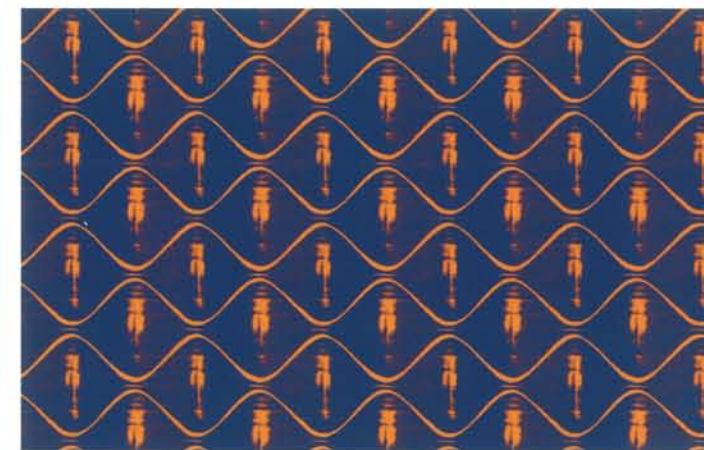
HelioSprintにより彫刻された均一な形を持つ完璧なセル形状 (スクリーン線数70 L/cm、角度3、100%濃度)
